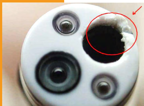
Fig. 12 Zona distal do endoscópio danificada.
